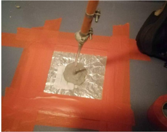
Kuva 43. Varastotilassa 1.5 merkkiainekeasua laskettiin välipohjarakenteen tyhjäan tilaan aiemmin tehdystä rakenneavauksesta.
