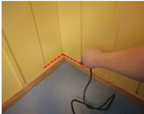
Kuvat 44 ja 45. Merkkiainevuotoa havaittiin varastotilan 1.5 ja leikkihuoneen 1.7 nurkissa.
