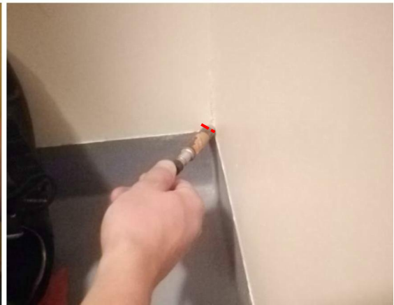
Kuvat 44 ja 45. Merkkiainevuotoa havaittiin varastotilan 1.5 ja leikkihuoneen 1.7 nurkissa.
